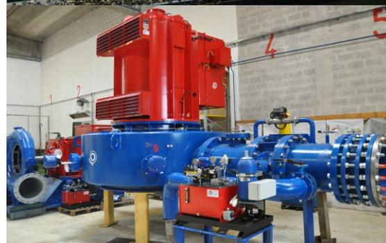
Турбины Пелтона, изготовленные в Сиapro, предназначены для следующих условий:
